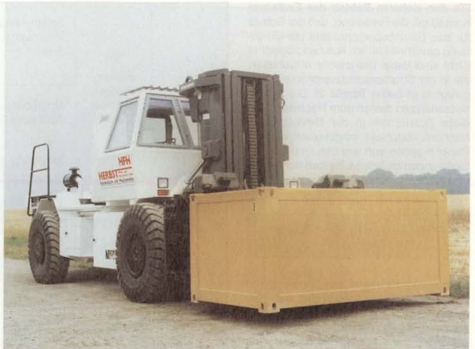
Bild 31: Das Einlagerungsfahrzeug ist mit auswechselbaren Tragvorrichtungen versehen und kann alle Gebindetypen aufnehmen.
