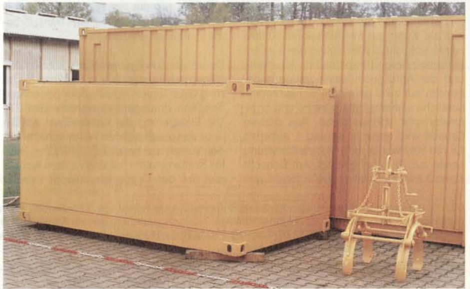
Bild 25: Container Typ V mit Faßgreifer.
