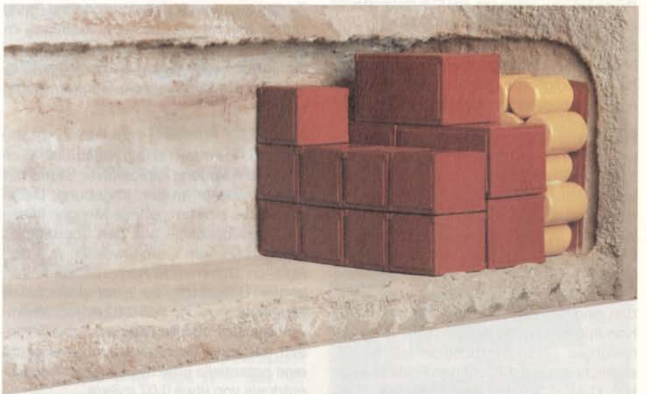
Bild 32: Modell einer Einlagerungskammer mit Containern und Rundgebinden.
