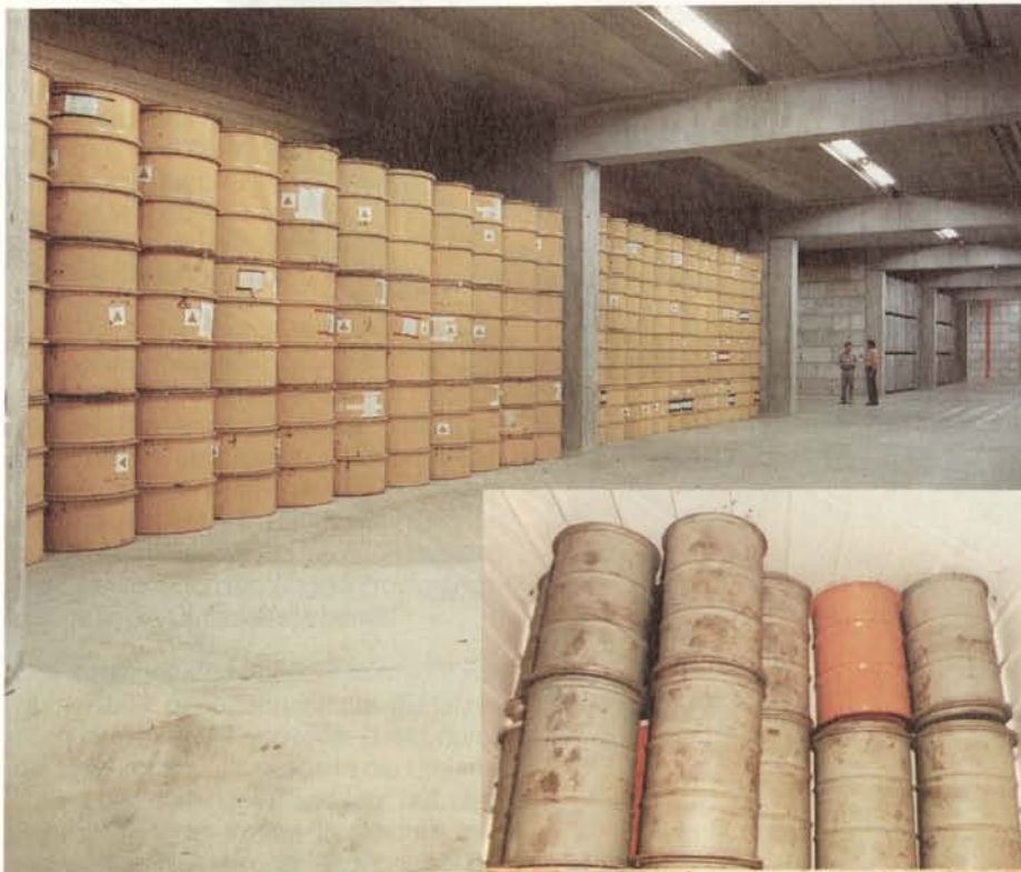
Bild 25a: Container (hier Typ V) können auch direkt mit Abfallprodukten befüllt werden.
