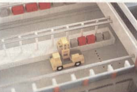
Bild 30: Modell der Pufferhalle mit Seiten- stapelfahrzeug.
