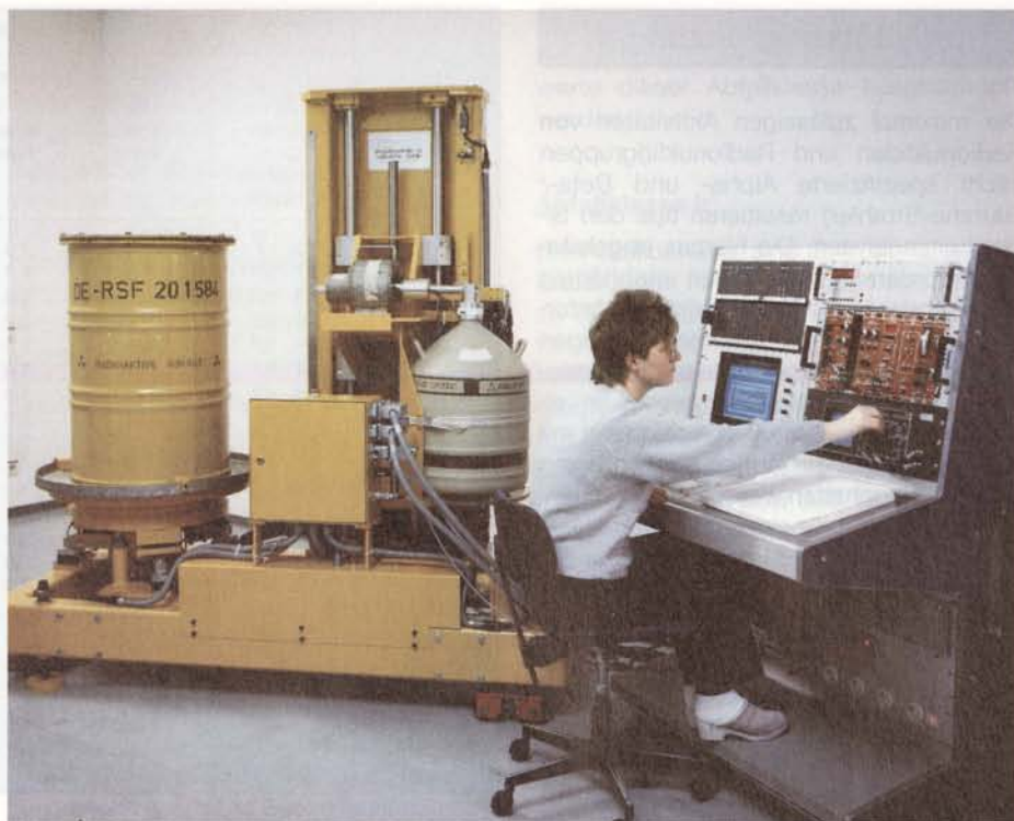
Bild 38: Direkte Produktkontrolle durch Gamma-Spektroskopie: Die von den Radionukliden im Faß (links) emittierten Gammastrahlen werden mit Hilfe eines hochempfindlichen Germanium-Detektors (Bildmitte) erfaßt und ausgewertet.
