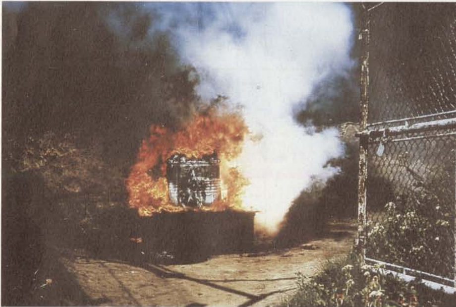
Bild 34: Brandversuch: An inaktiven Simulaten wird untersucht, wie sich Abfallgebinde bei einem Brand verhalten. Die mit den Rauchgasen freigesetzte Materie wird auf Filtern gesammelt und ausgemessen, um festzustellen, wieviel Radioaktivität im Brandfall aus einem Abfallgebinde freigesetzt werden kann.
