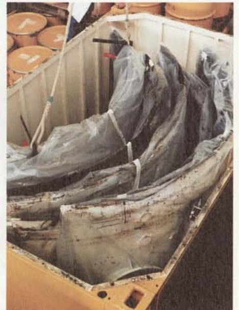
Bild 25a: Container (hier Typ V) können auch direkt mit Abfallprodukten befüllt werden.
